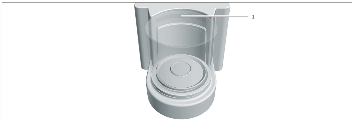
Fig. 7: Iluminación de la cámara de pesaje (ejemplo)
